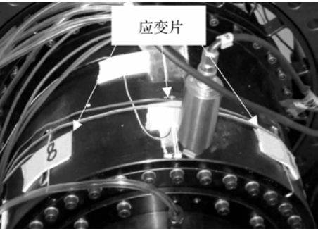
图 12 位于 1# 支点处的支承锥壁局部应变测点
